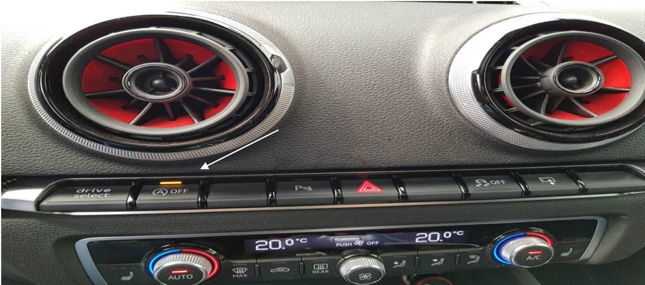
Die AVC verfügt über eine **SSA-Memory** Funktion. Der letzte Zustand wird gespeichert und nach Motorstart wiederhergestellt.
