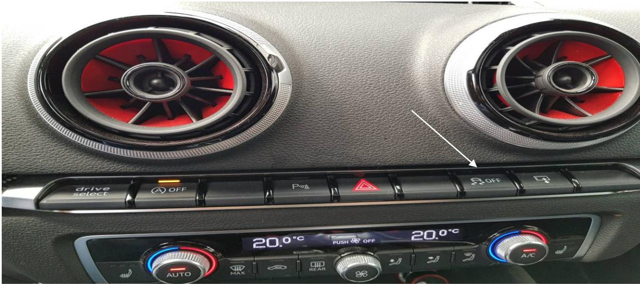
Mit Hilfe der **ESP-Taste**, können Sie die Klappensteuerung vollständig deaktivieren.
